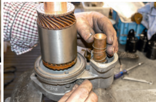
Beim Zusammenbau hängt Jahn den Kern des Magnetschalters in die Ausrückgabel ein
