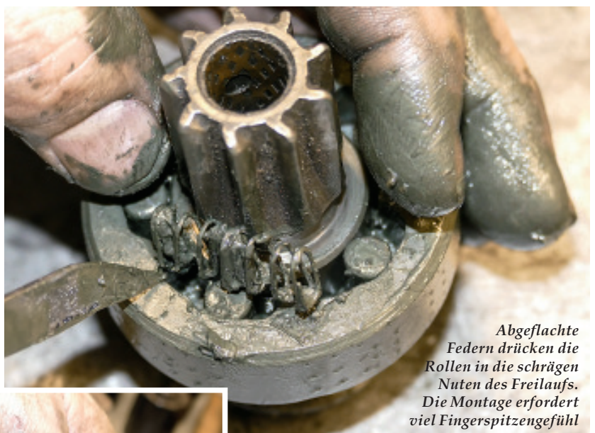
Auf der Verzahnung läuft der Freilauf mit dem Anlasserritzel. Der betätigte Magnetschalter rückt die Ritzeleinheit in den Zahnkranz der Schwungscheibe
