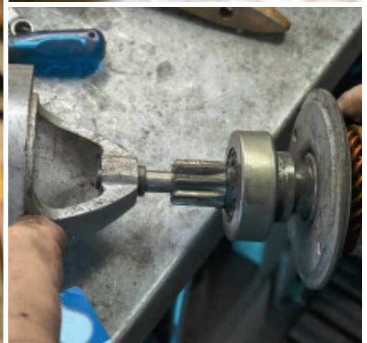
Die vordere Lagerbuchse prüft Wilhelm Jahn durch Einstecken der Ankerwelle
