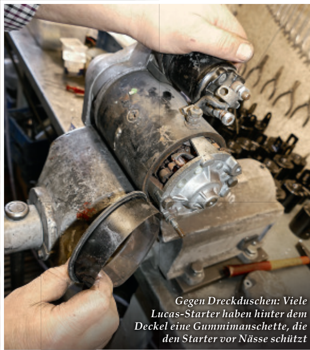
Nach dem Abschrauben des hinteren Deckels lässt sich das Anlassergehäuse samt Feldwicklungen vorsichtig abziehen
