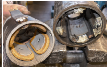
Im Vergleich mit einer neuen Feldwicklung (links) sind die Hitzeschäden eindeutig erkennbar
