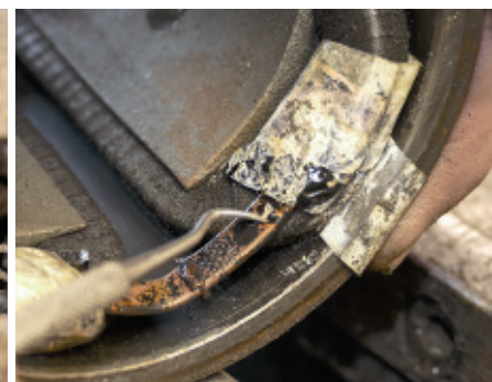
Überlastungswärme führte zum Verbrennen des Isolierlacks und der Gewebeisolierung
