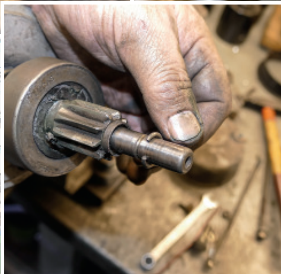
Ein Sprengring hält das Ritzel an seiner Position. Am Ende wird noch eine Hülse über den Ring gezogen
