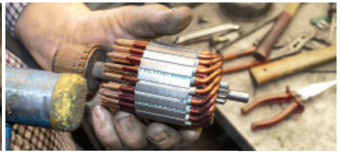
Beim Bau eines neuen Ankers kommt es auf die exakte Positionierung des Wicklungspaketes an
