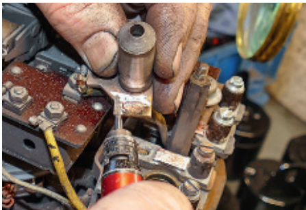
Kontaktkaries: Die Flächen glättet Jahn mit einem Handfräser. Damit sind die Kontakte wieder gut für tausende Startvorgänge
