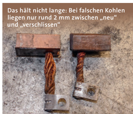
Erosionsopfer: Ohne ausreichend Federdruck funkt es zwischen Anker und Kohle. Der starke Materialabtrag zerstört am Ende Kohle und Kollektor
