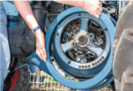
Zum Ausbau Platz schaffen: Als erstes werden Anwerfscheibe und Schwungradabdeckung des Bulldog entfernt, es folgt die Batterie
