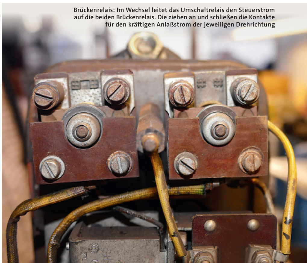
Das Umsteuerrelais leitet den Steuerstrom im Wechsel auf die Magnete des Brückenrelais und schließt so die „heißen“ Kontakte
