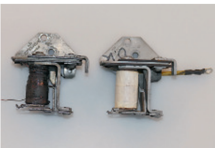
... Unterbrecherrelais) gibt einen Impuls aufs Umschaltrelais. Links ein Relais mit defekter Spule, rechts ein neu gewickeltes Exemplar
