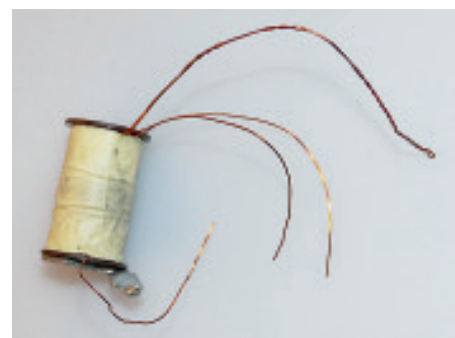
Der Spulendraht ist durch Lack isoliert. An den Enden entfernt Jahn die Schutzschicht und verlötet die Spule mit dem Relais
