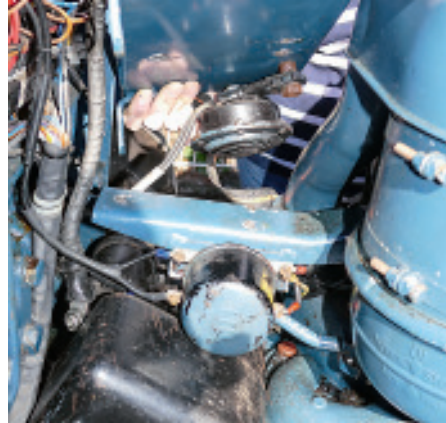
Nach ihrem Ausbau löst man den Batteriehalter, hier sind das zwei Schrauben und nimmt ihn komplett ab. Erst so ist der Anlasser erreichbar
