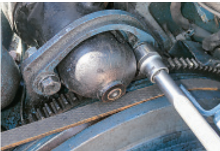
Mit dem Lösen der beiden Halteschrauben hier am Bügel (Lanz D 2016) lässt sich der Anlasser schön nach links herausnehmen
