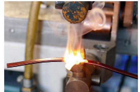
Löten durch Strom: Mit einem kräftigen Draht demonstriert der Experte den induktiven Schweißvorgang
