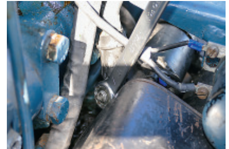
Dann die Steuerleitung zum Magnetschalter (SW 7) und das Pluskabel abschrauben. Beide Verschraubungen sind schlecht zugänglich
